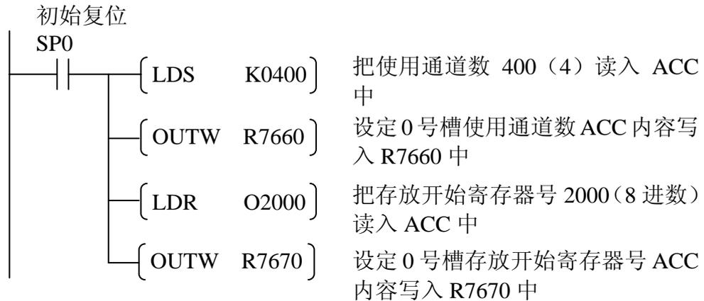
仅需以上的设定, 用户就可以使用对应实际计数通道的 R2000 ~ R2003 的数据。
