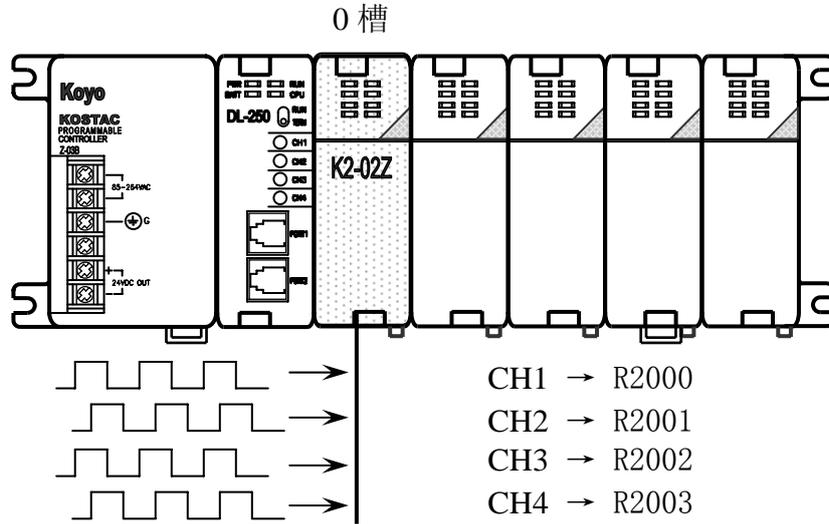
计数数据读入设定程序 (不论实际使用几个通道, 本模块一律应设定为使用 4 个通道)
